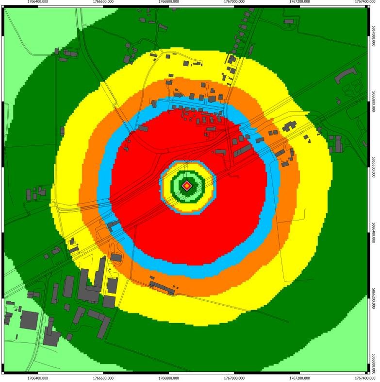
Campo elettromagnetico (V/m) calcolato alla quota di 16,9 m sul livello del terreno
