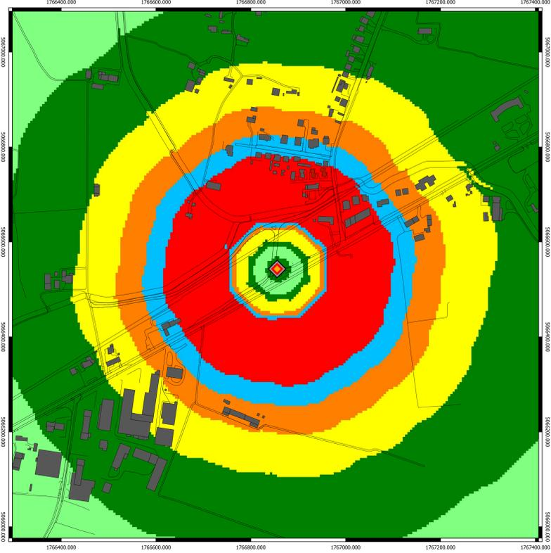
Campo elettromagnetico (V/m) calcolato alla quota di 14,9 m sul livello del terreno
